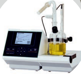
Kulometrik Karl Fischer Titrator Nem analizi için
